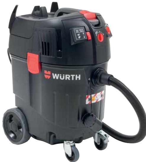
**Speziell zertifizierter Sicherheitssauger der Staubklasse M für trockene, nicht brennbare, gesundheitsgefährdende Stoffe mit MAK-Werten größer 0,1 mg/m<sup>3</sup>. Es dürfen keine krebserzeugende Stoffe, außer Holzstaub, aufgesaugt werden.**
