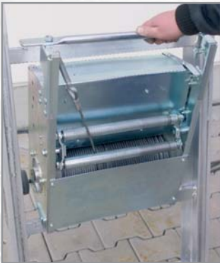
Das Antriebsaggregat wird bequem von vorne eingehängt und verfügt über eine automatische Verriegelung
