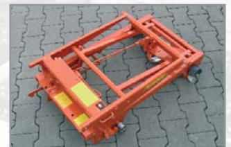
Kippschlitten mit Fallbremse und automatischer Sicherheitsverriegelung
