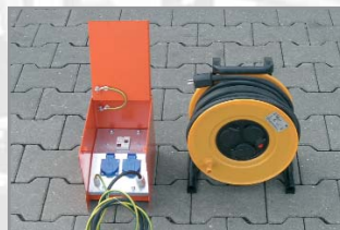
Kabeltrommel, 40 m, 2,5 mm 2 und Kleinbaustromverteiler
