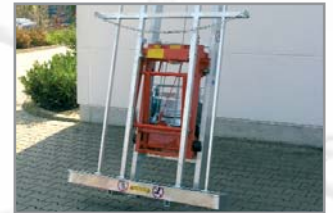
Pritsche für Wellplattentransport, 130 cm breit
