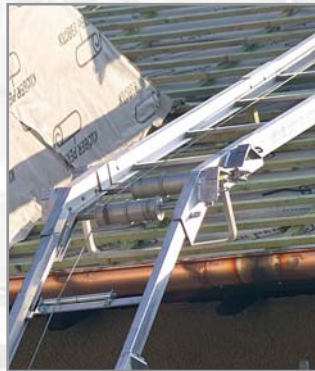
Das Knickstück kann stufenlos von 20 bis 45 Grad verstellt werden
