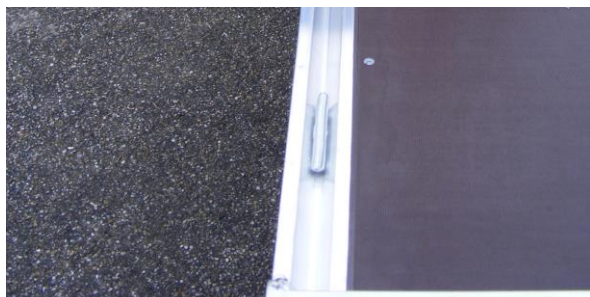
Zurrbügel seitlich versenkt im Außenrahmen
