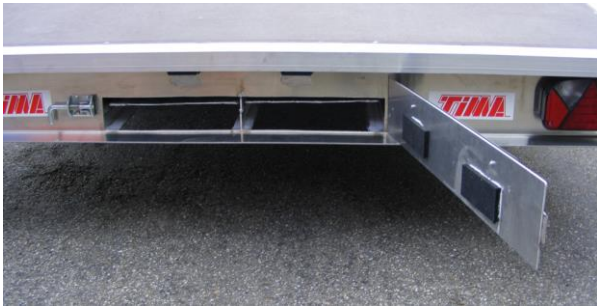
zweiteilige Auffahrampen in Fahrstellung
